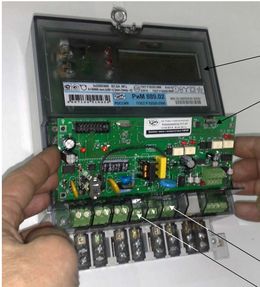
Фото 2. Установка коммуникатора в интерфейсный отсек счетчика
