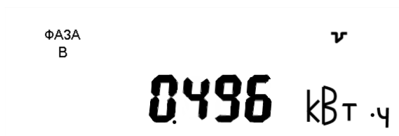
Рисунок Е.9 – Пример индикации значения суммарного потребления активной энергии по всем тарифам по фазе «В».
