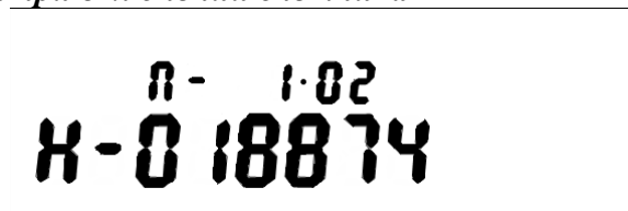
Рисунок Е.1 – Пример индикации номера версии и заводского номера счетчика (версия счетчика 1.02, заводской номер 018874)
