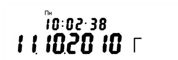
Рисунок Е.11 – Пример индикации текущей даты и времени ЧРВ счетчика.
