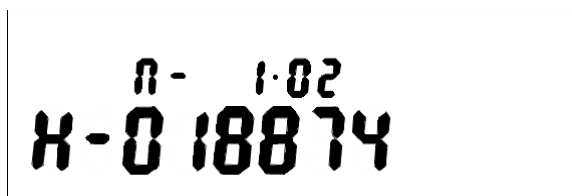
Рисунок Д.1 – Пример индикации номера версии и заводского номера счетчика (версия счетчика 1.02, заводской номер 018874)
