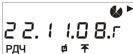
Рисунок 17 – Пример индикации даты фиксации пиковой мощности на РДЧ (последнее из зафиксированных значений)
