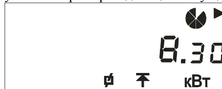
Рисунок 9 – Пример индикации текущей пиковой мощности
