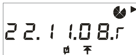
Рисунок 10 – Пример индикации даты фиксации текущей пиковой мощности
