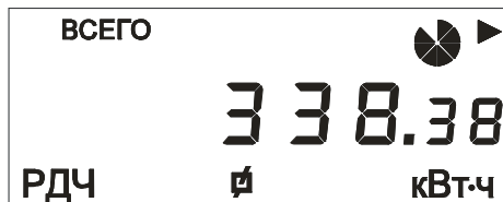
Рисунок 14 – Пример индикации суммарного потребления на РДЧ
