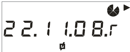
Рисунок 12 – Пример индикации текущего времени ЧРВ счетчика
