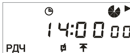
Рисунок 18 – Пример индикации времени фиксации пиковой мощности на РДЧ
