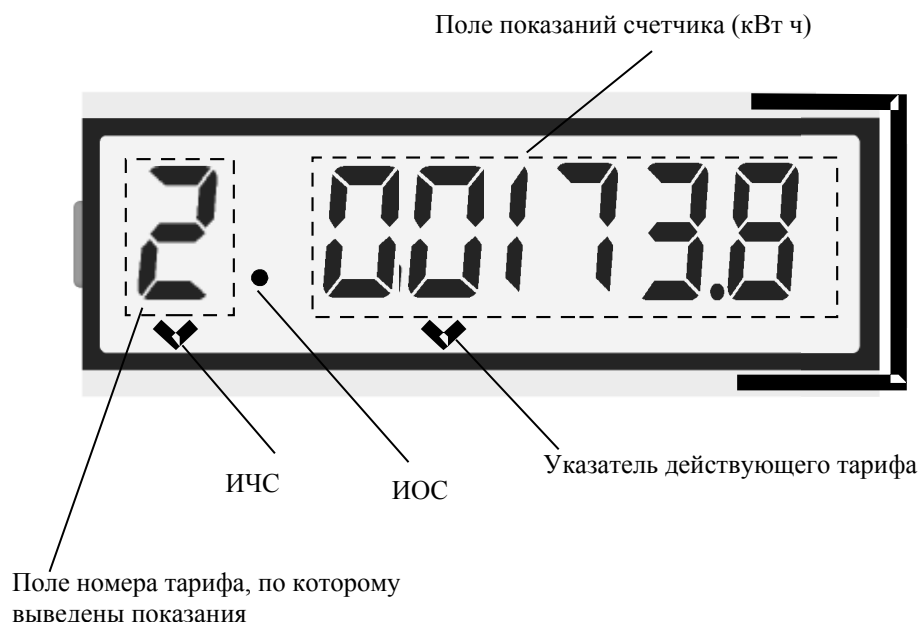
Рисунок 3 – Пример отображения измеряемых величин и индикаторов на дисплее счетчика
