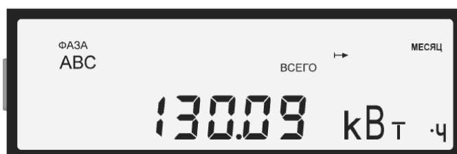
Рисунок 9 – Пример вывода суммарных показаний на РДЧ в многотарифном режиме
